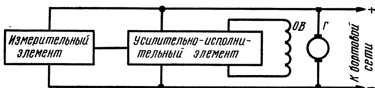
Рис. 1. Структурная схема регулятора
